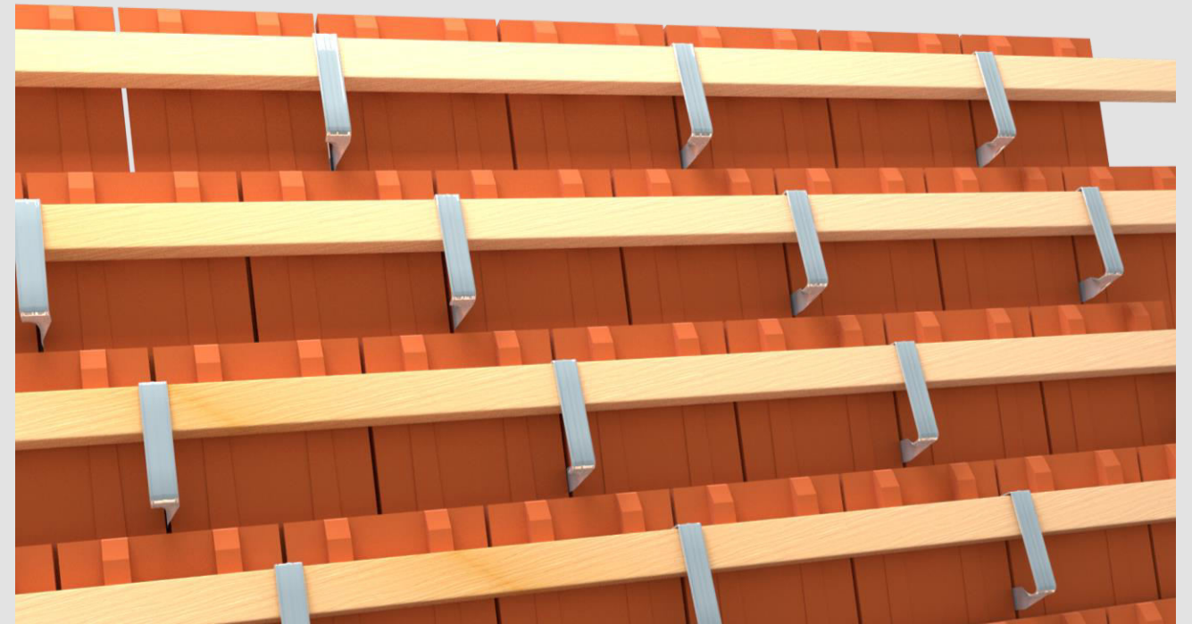
Séma 1:2 beakasztós viharkapocshoz, kettősfedésű hódfarkú cserépfedéshez
