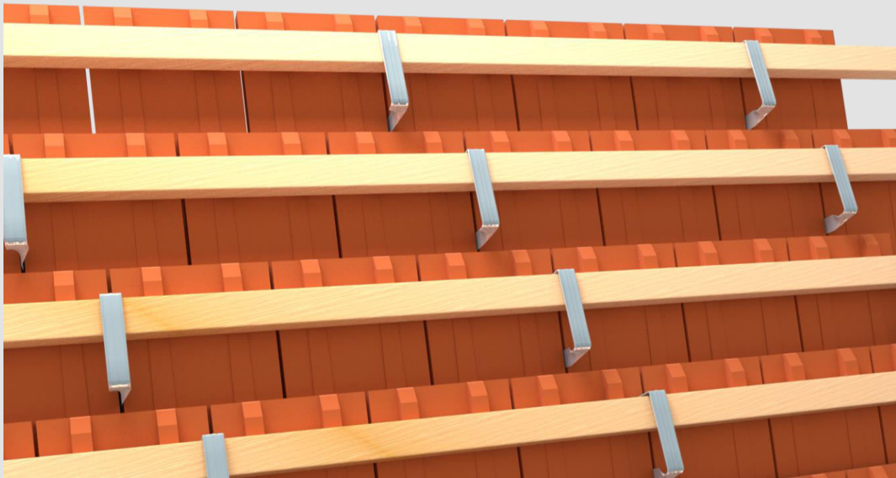
Séma 1:3 beasztós viharkapocshoz, kettősfedésű hódfarkú cserépfedéshez
